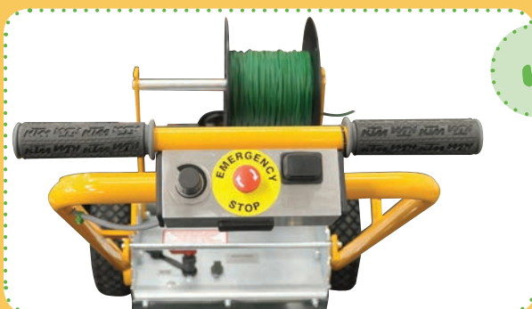
Traploze snelheidsregeling VOOR én ACHTERUIT Réglage de vitesse en continu AVANT et Arrière
